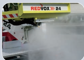
Buse d'auto-protection pour refroidissement des lieux d'intervention à températures élevées
