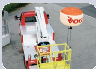
Différents systèmes d'éclairage sur la nacelle: • Ballon éclairant • Projecteur supplémentaire 1000W/230V • Projecteur d'intervention 70W/12V • Projecteur aux halogènes • Éclairage LED
