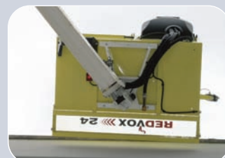
Rotation nacelle 2 x 60°: la fenêtre est desservie au millimètre près
