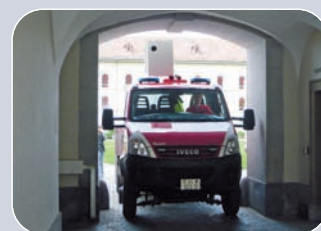
Franchissement aisé des passages bas et réduits. Largeur: 2,1 m - Hauteur: 2,8 m
