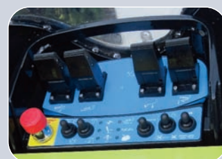
Pupitre de commande clair et sensible dans la nacelle, avec commande proportionnelle
