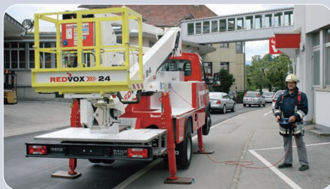
Télécommande par pupitre de contrôle identique sur la tourelle pivotante et dans la nacelle Manoeuvre prioritaire sur la tourelle
