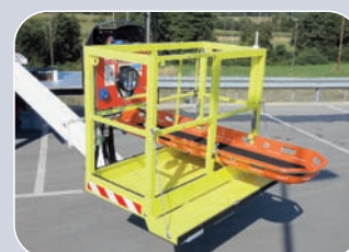
Dispositif de maintien stable de brancard pour transport au bord de la nacelle
